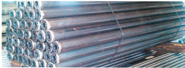
写真-3: 圧縮パイル用の口元補強管
