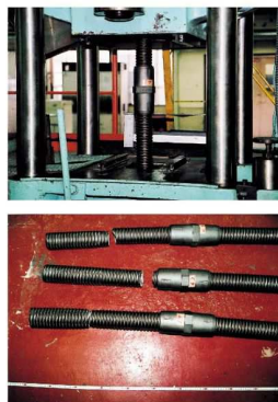
SPボルトの試験状況
