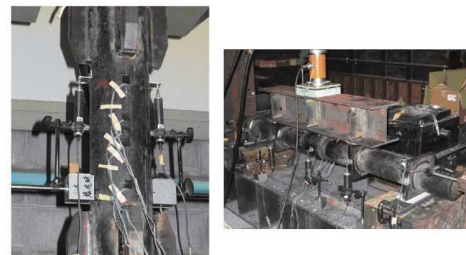
鋼管ジョイントの試験状況
